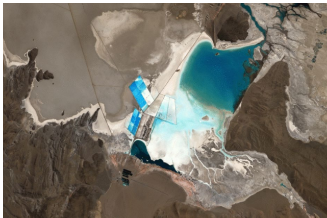
Con el fin de extraer la salmuera la empresa LIVENT realiza perforaciones y obtiene 900 m 3 /hora de salmuera del centro del salar, las cuales se depositan en unos piletones.
