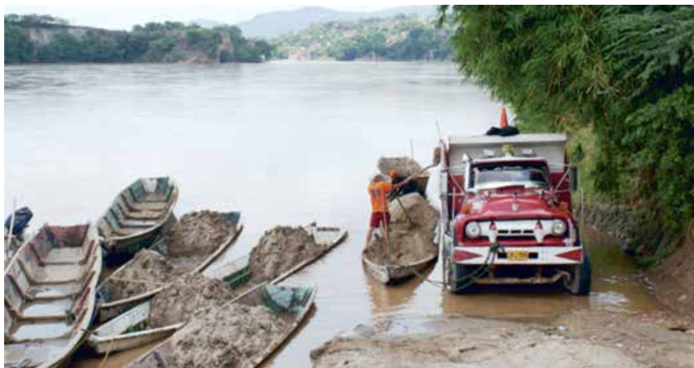
● Río Magdalena- Extracción artesanal de arena para construcción. Foto Asociación Ambiente y Sociedad
